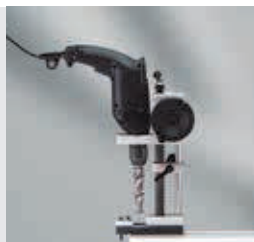
Die Bohreinheit kann mit einer handelsüblichen Bohrmaschine mit Euroaufnahme ( \varnothing 43 mm) betrieben werden. Zu empfehlen ist eine Maschine mit elektronischer Drehzahlregelung, R/L-Lauf und 2-Gang-Getriebe.
