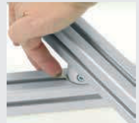
Demontage: Nach dem Lösen der Spannschraube wird das Riegelblech aus der Profilvernut gehoben und zurückgeschwenkt. Der KLICK-Verbindungssatz muss nicht zerlegt werden und ist sofort wieder für den nächsten Einsatz bereit.
