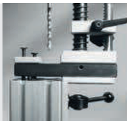
Durchgangsbohrung und Gewinde für den Standard-Verbindungssatz.
